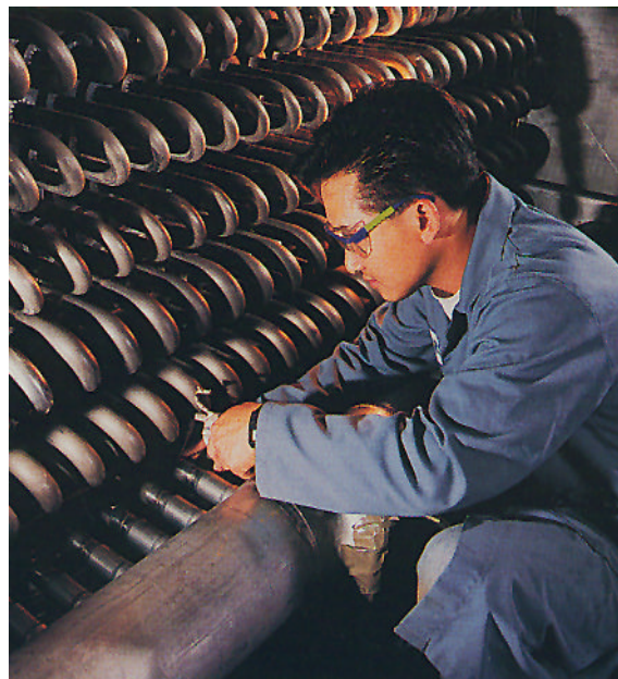
Fig. 4 IST Once-Through Tube Bundle
